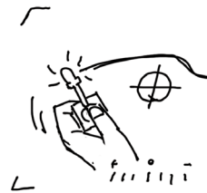
ยึด LED กับแบตเตอรี่ด้วยเทปพันสายไฟ
